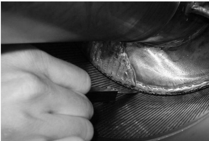
Abb. 13-15: Messung des Arbeitsspalt zwischen Sieb und Schnecke, gemessen wird an der Unterseite des Siebes bei Stillstand der Maschine, die Messung ergibt den 2-fachen Arbeitsspalt, da im ruhenden Zustand das Sieb oben auf der Schnecke aufliegt.
