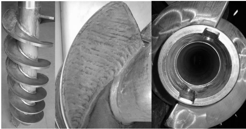
Abb. 13-12: Schnecke mit gepanzertem Spezialwerkstoff und Nabenaufnahme, Neuzustand
